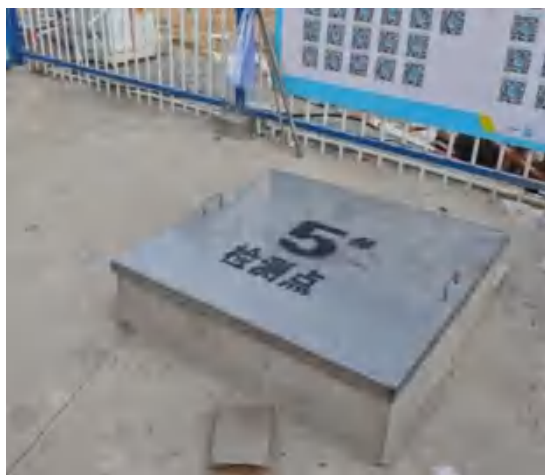
地下水监测井5#
