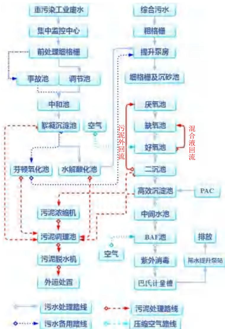
图 7.1-14 中德金属生态城综合污水处理厂工艺流程图
