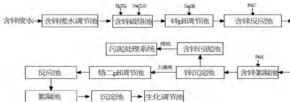
图 8.1-2 含锌废水预处理工艺流程图
