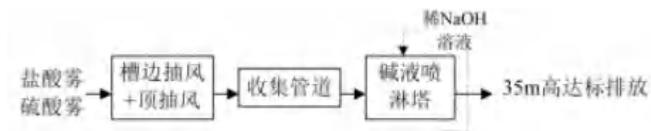
图7.3-1 酸雾废气处理系统工艺流程
