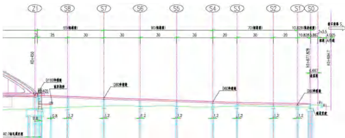
图2-12 立面布置图（南侧车行道引桥）
