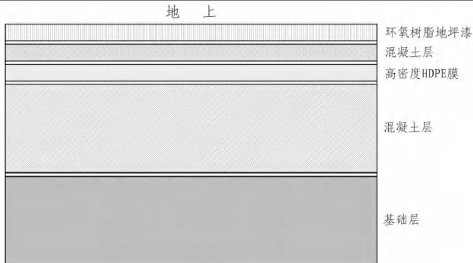
图 2-1 项目拟设置防渗层结构示意图
