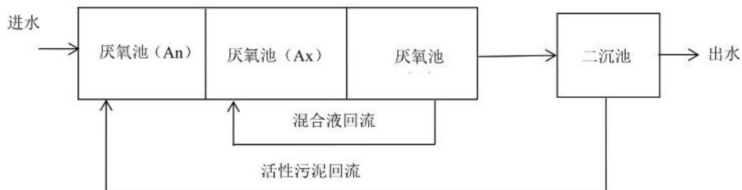
图 4-2 磐东污水处理厂工艺流程图
