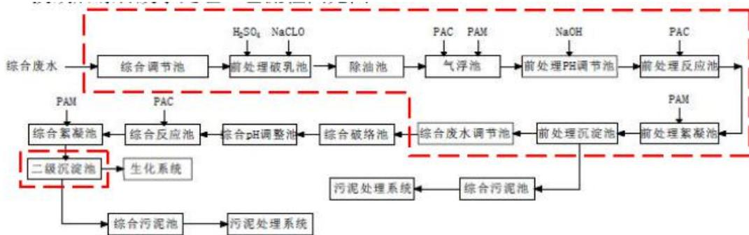
图 2-7 综合废水物化处理工艺流程图
