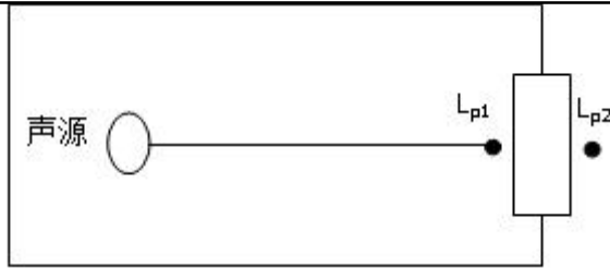
图 4-1 室内声源等效为室外声源图例
