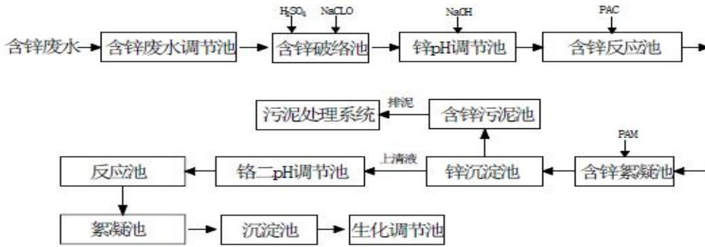
图 2.4-6 含锌废水预处理工艺流程图
